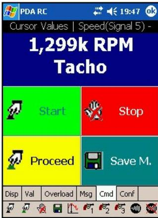
Neben der Möglichkeit über die Standard-Schaltflächen das PULSE System zu steuern, kann auch ein eigenes Dialogfeld mit wenigen wichtigen Schaltflächen bestückt werden. Dadurch ist eine „Daumen-Bedienung“ möglich, die auch unter erschwerten Bedingungen eine stiftlose Steuerung des PULSE-Systems zulässt.
