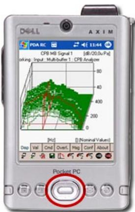
Der Cursor eines Displays kann mit Hilfe der Richtungstasten der Navigationswippe in X- und Z-Richtung verschoben werden. Das hat weiter Einfluss auf die Werte des Value-Dialogfeldes, wenn „Cursor Value“ für dieses Display angezeigt wird. Umgekehrt kann ein
